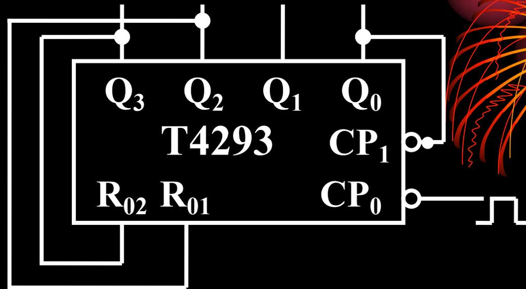
选用CP<sub>0</sub>为输入， Q<sub>3</sub>~Q<sub>0</sub>为输出。
