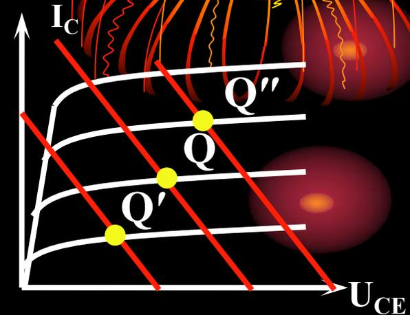
负载线斜率不变,  $I_B$ 变化。
