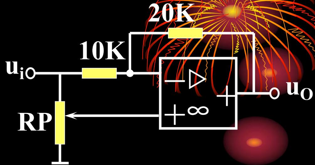
滑动头在最上端，电路为差动电路
