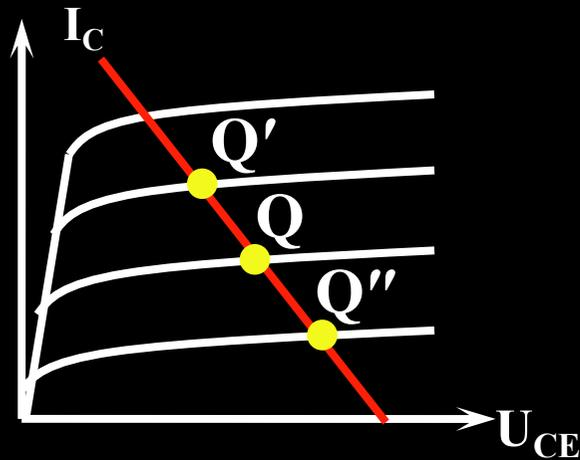
负载线斜率不变,  $I_B$ 变化。
