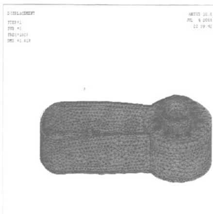
图 3-13 小臂五阶振型图
