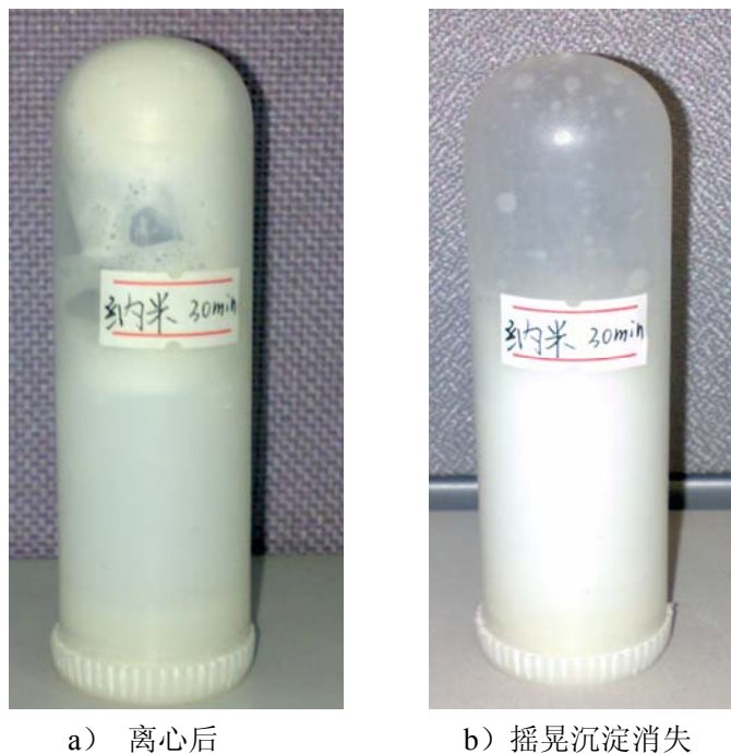
图 3-11 纳米 SiO 2 浸润剂离心沉降处理
