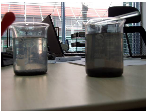
图 7 左为印染废水加入 FT 高效脱色剂，右为印染废水加入饮用水级 PAC。
