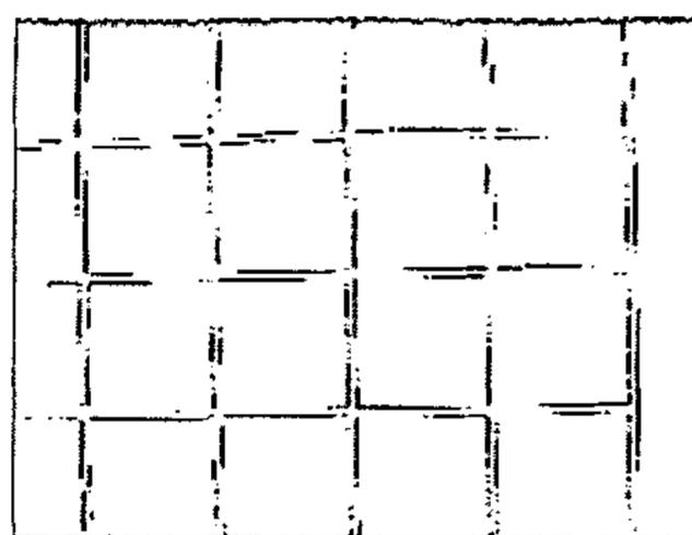
图 3.6 径向畸变引起的桶形失真
