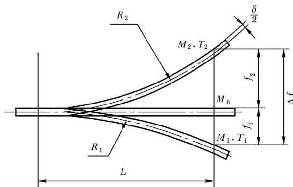
图 1 热双金属弯曲示意图
