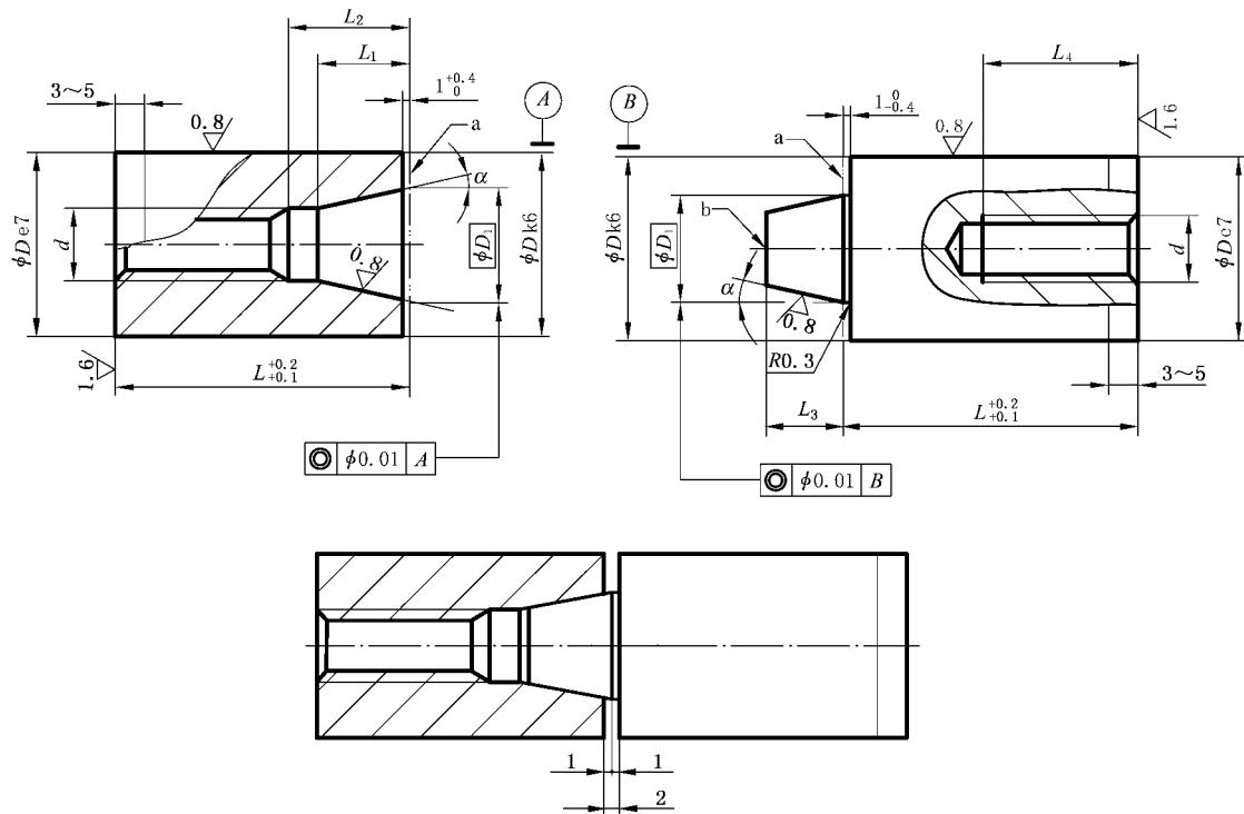
未注表面粗糙度  $R_a = 6.3 \mu\text{m}$ ; 未注倒角  $1 \text{ mm} \times 45^\circ$ 。
