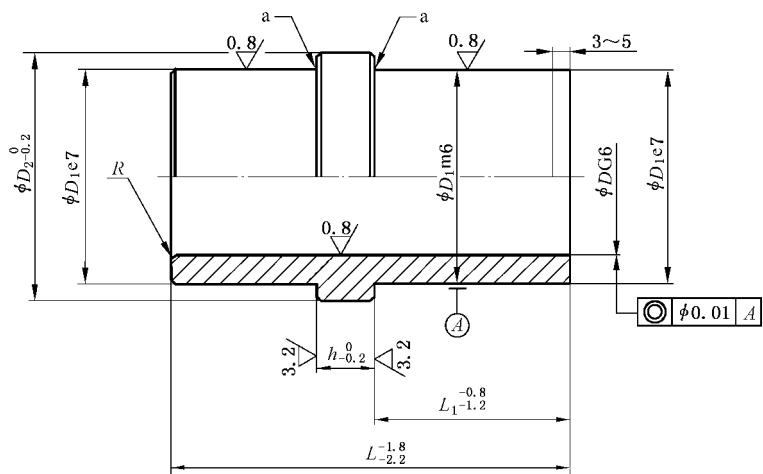
未注表面粗糙度  $R_a=6.3 \mu\text{m}$ ; 未注倒角  $1 \text{ mm} \times 45^\circ$ 。
