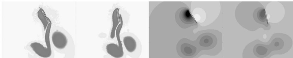
图 3.15 一个周期内不同拍动模式下的涡量、压强比较图。第一列为超前转动模式涡量图，第二列为对称转动模式涡量图，第三列为超前转动模式压强图，第四列为对称转动模式压强图。 $\theta_1$  为超前转动模式正迎角， $\theta_2$  为对称转动模式正迎角。压强图中白色表示高压，黑色表示低压。
