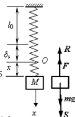
7. 质量  $m=2\text{kg}$  的质点在恢复力和正弦形扰力作用下沿  $x$  轴运动。恢复力  $F_r=-8x$  N, 扰力  $S_x=0.4\cos t$  N。已知: 当  $t=0$  时,  $x_0=0$ , 试求质点的运动规律。
