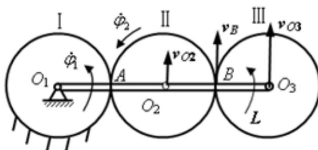
解: 系统是一个自由度, 取曲柄的转角  $\varphi_1$  为广义坐标。轮 I 不动, 轮 II 和 III 轮作平面运动。
