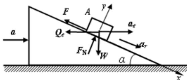
解：取  $A$  为研究对象，动系固连接柱。
