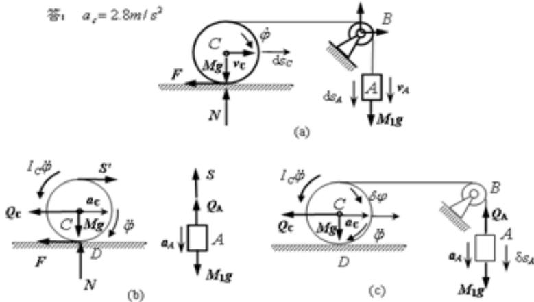
解一: 用达朗伯原理, 分别取重物 A 和滚子为研究对象(图 b), 在重物上加惯性力  $Q_A = -M_1 a_A$ , 在滚子上加惯性力  $Q_c = -M a_c$  和矩为  $-I_c \dot{\varphi}$  的惯性力偶, 其中  $r \dot{\varphi} = a_c = \frac{1}{2} a_A$ . 对重物 A, 有
