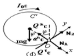
5. 匀质轮子半径是  $r$ ，重量是  $G$ ，在水平面上滚动而不滑动，不计滚阻。试问在下列两种情况下，轮心  $C$  的加速度是否相等？接触点  $A$  的滑动摩擦力是否相等？(a) 轮上作用一个顺时针的常值力偶，其力偶矩是  $M_0$ ；(b) 轮心  $C$  上作用一个水平向右的常力，其大小
