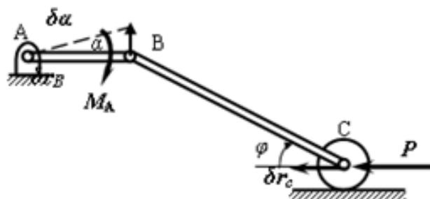
解: 给杆 AB 虚位移  $\delta\alpha$ , 轮 C 同时获得虚位移  $\delta r_c$ .
