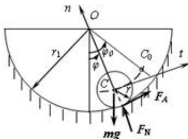
注意: (3) 式中  $\omega$  和对质心力矩以顺时针为正, 但  $\varphi$ 、 $\dot{\varphi}$ 、 $\ddot{\varphi}$  以逆时针为正.
