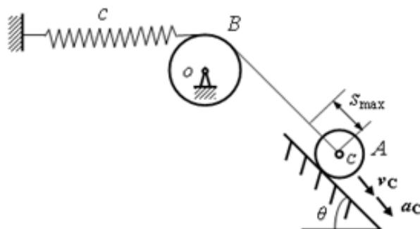
13. 物体 A 质量  $m_1$ ，挂在不可伸长的绳索上；绳索跨过定滑轮 B，另一端系在滚子 C 的轴上，滚子 C 沿固定水平面滚动而不滑动。已知滑轮 B 和滚子 C 是相同的匀质圆盘，半径都是  $r$ ，质量都是  $m_2$ 。假设系统在开始处于静止，试求物块 A 在下降高度  $h$  时的速度和加速度。绳索的质量以及滚动摩擦阻和轴承摩擦都不计。
