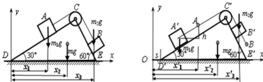
解：取整个系统为研究对象。系统的外力只有铅直方向的重力  $m_1g$ 、 $m_2g$ 、 $mg$  和法向反力  $N$ 。又因系统在初瞬时处于静止，故整个系统的质心在水平方向  $x$  的位置守恒，即  $x_C = x'_C$ 。
