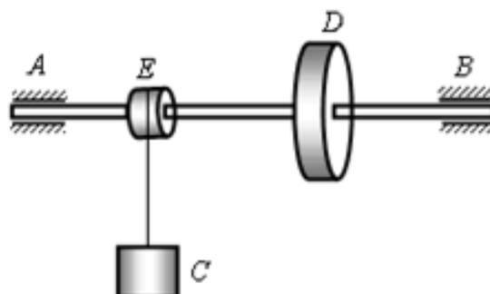
解：对整个系统应用动量矩定理，设被测物体对转轴  $z$  的转动惯量为  $I$ ，
