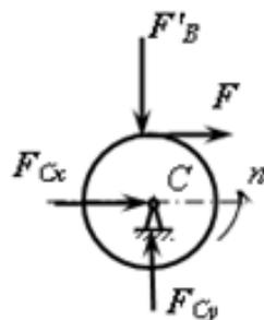
3. 鼓轮的质量  $m_1 = 1800\text{kg}$ ，半径  $r = 0.25\text{m}$ ，对转轴  $O$  的转动惯量  $I_O = 85.3\text{kg}\cdot\text{m}^2$ 。
