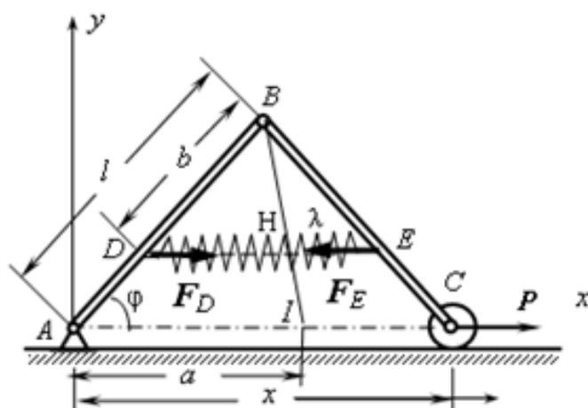
解：取系统为研究对象，解除弹簧约束，代以相应的弹力  $F_D$  和  $F_E$ ，取倾角  $\varphi$  为广义坐标。设弹簧的变形量为  $\lambda$ ，则有  $\lambda=HE$ 。
