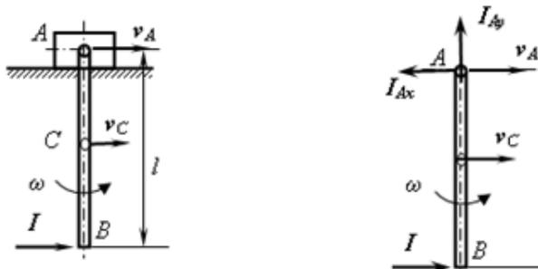
解：设杆撞后角速度为  $\omega$ ，质心速度为  $v_c$ ，对系统应用动量定理
