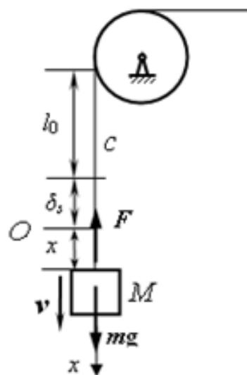
4. 在弹簧上悬挂质量  $m=6\text{kg}$  的物块。当无阻力时，物块的振动周期是  $T=0.4\pi\text{s}$ ；而在有正比于速度一次方的阻力时，振动周期  $T_1=0.5\pi\text{s}$ 。现在把物块从静平衡位置下拉  $4\text{cm}$ ，然后无初速度的释放，求以后物体的振动规律。
