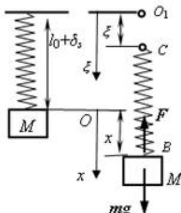
解：取弹簧上端不动时物块的平行位置作为固定坐标轴系的原点，令  $Ox$  轴铅直向下。在任意瞬时  $t$  物块  $m$  的坐标为  $x$
