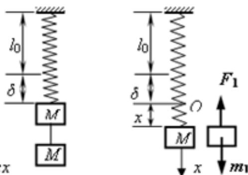
3. 质量  $m=2000\text{kg}$  的重物在吊索上以匀速  $v=5\text{ m/s}$  下降。由于吊索突然嵌入滑轮的夹子内，其上端被卡住不动。试求以后重物振动时吊索的最大拉力。假定吊索上端被卡住以后，下端吊索的弹簧刚度系数  $c=3920\text{ kN/m}$ ，又吊索质量不计。
