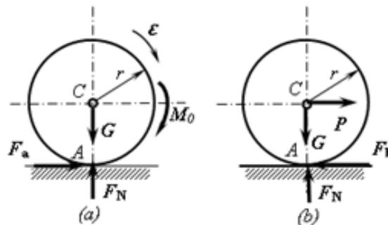
解：匀质轮子作平面运动，应用刚体平面运动微分方程。
