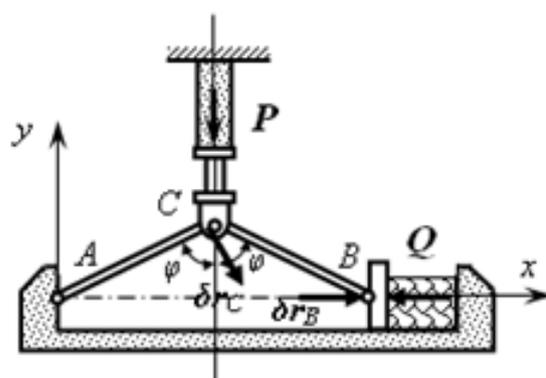
2. 图示机构中的长度  $AB = \frac{1}{2}BC = r$ , 当杆 AB 水平时, 杆 BC 对水平面的倾角是  $\varphi$ . 求在
