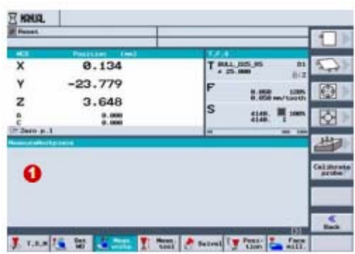
①测量工件的边缘，角/孔，矩形，平面
