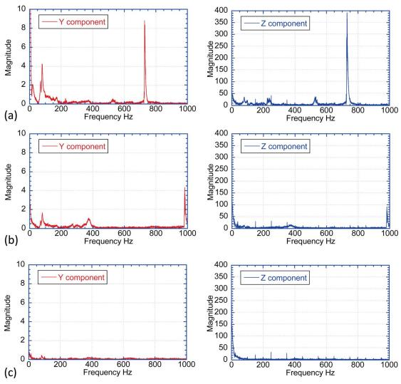
图 8: 频率分析: (一) 无支撑线的电线, (二) 线夹持在支护装置, 和(三) 钢丝固定在支撑装置上, 用聚氨酯管
