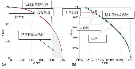
图 12: 工件表面的刀具运动轨迹: (一) 在四分之一的工件和(二) 放大
