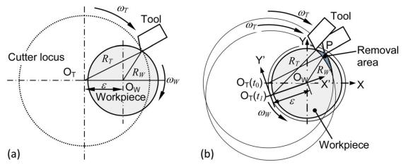
图 9: 旋风加工: (一) 实际切削过程中旋转和(二) 分析模型的旋转
