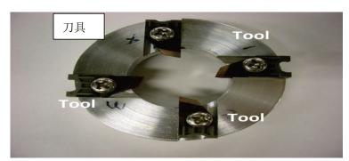
图 3: 安装在旋转环上的工具
