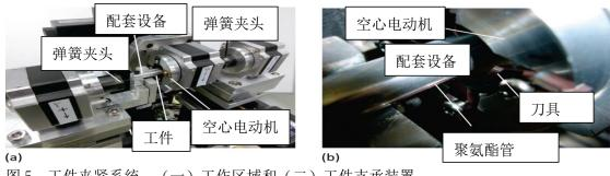
图 5: 工件夹紧系统: (一) 工作区域和(二) 工件支承装置
