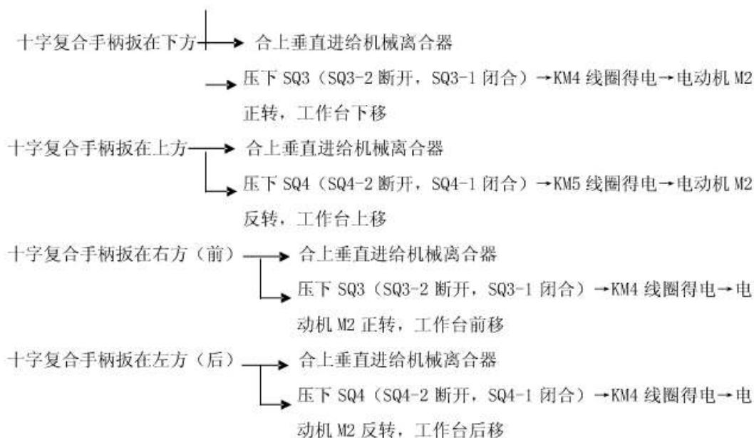
图 3-3 工作台横向与垂直方向进给过程
