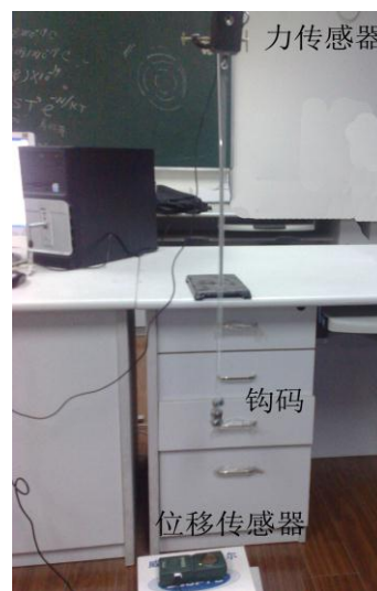
图 4-12 利用 DIS 研究 竖直方向弹簧振子运动
