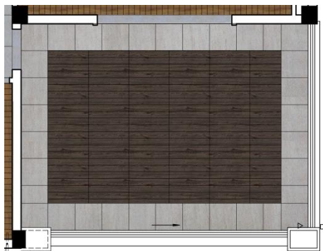
顶层露台铺贴仿木纹砖
