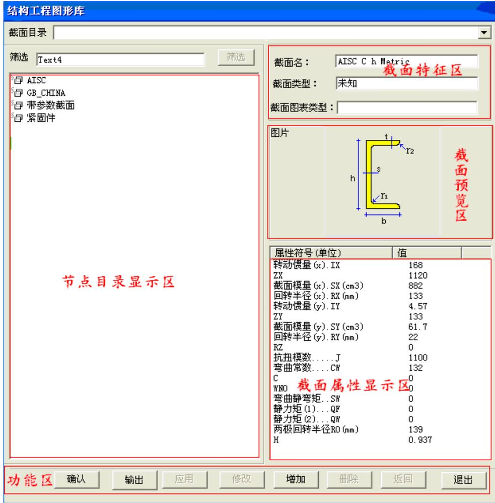
图 3.10 结构工程图形库主界面
