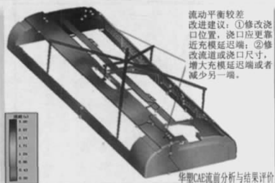
图6 空调盖板流动前沿、熔接痕分析
