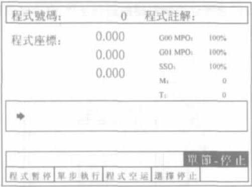
图 4 滚齿机数控系统单段运行操作界面
